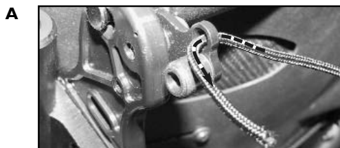
Enfie o fio pelo mecanismo de fecho.
