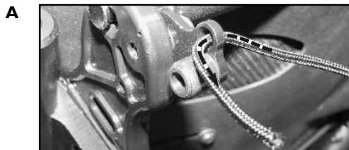
Trä snöret genom låsmekanismen.
