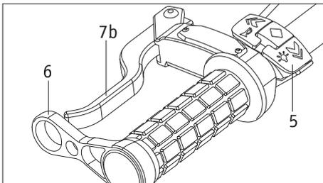
Mit Ausnahme der beiden Bremshebel [7a, 7b] muss zur Nutzung der Bedienelemente der Akku-Pack eingeschaltet sein (siehe Kapitel 3.4).
