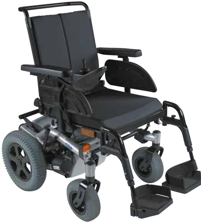
Der *Invacare® Stream* ist ein solider Elektro-Rollstuhl. Kompakt und wendig eignet er sich ideal für den Innenbereich und überzeugt mit der serienmäßigen Beleuchtung und der Hinterrad-Federung auch bei Fahrten im Außenbereich. Der einstellbare Sitz kann einfach an unterschiedliche Nutzer angepasst werden.
