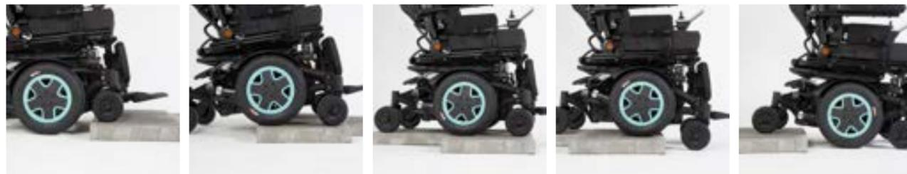
Beim Befahren eines Hindernisses gehen die Vorderrad-Aufhängungen automatisch nach oben. Beim Hinunterfahren gehen die Vorderrad-Aufhängungen automatisch nach unten. Der Nutzer sitzt stabil und sicher, seine Position verändert sich kaum, während die Reifen über das Hindernis fahren (Höhen von bis zu 75 mm).
