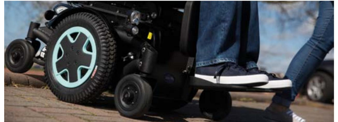
Mit **Stability Lock** bleiben alle sechs Räder fest auf dem Boden, wenn der Nutzer über unebenes Terrain fährt. Der Sitz bleibt waagrecht, der Oberkörper bleibt in Balance.
