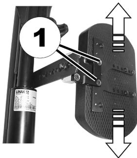
1. Schrauben (1) mit dem Innensechskantschlüssel lösen.
