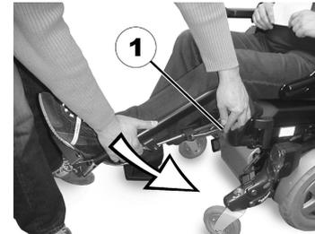
1. Beinstütze im Fußplattenbereich halten, seitlichen Verstellhebel ziehen (1) und Beinstütze langsam absenken.
