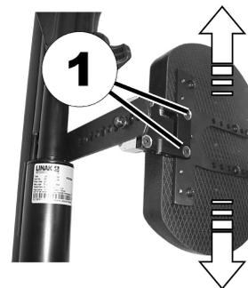
1. Schrauben (1) mit dem Innensechskantschlüssel lösen.
