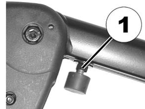
Kontermutter (1) mit dem Gabelschlüssel lösen.
