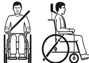
1. Bringen Sie das 3-Punkt-Personenrückhaltesystem entsprechend der Gebrauchsanweisung des verwendeten 3-Punkt-Rückhaltesystems an.
