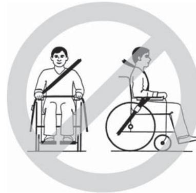
Der Sicherheitsgurt darf nicht durch Rollstuhlteile, wie Armlehnen oder Räder, vom Körper des Benutzers ferngehalten werden.
