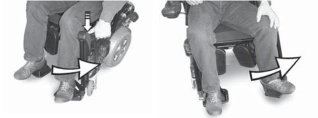
Beinstütze entriegeln und nach außen schwenken.
