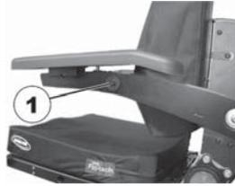
1. Lösen Sie die Schraube zur Verstellung des Armauflagen-Winkels (1) mit dem Innensechskantschlüssel.
