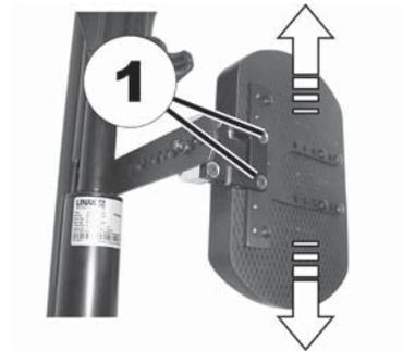
1. Schrauben (1) mit dem Innensechskantschlüssel lösen.
