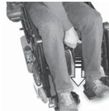
1. Wadenplatte gerade nach unten drücken. Die Wadenplatte ist entriegelt.
