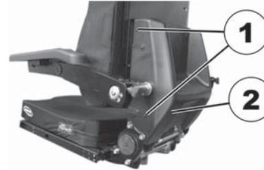
1. Lösen Sie die Schrauben auf beiden Seiten der Rückenabdeckung (1). In der Abbildung sind nur die Schrauben der linken Seite zu sehen.
