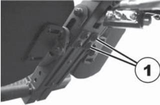
1. Lösen Sie die Schrauben (1) an der Rückseite der Beinstütze mit dem Innensechskantschlüssel.
