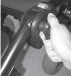
4. Ziehen Sie den Knauf mit dem Uhrzeigersinn fest.
