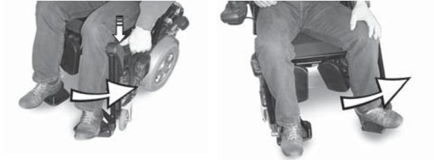
Beinstütze entriegeln und nach außen schwenken.
