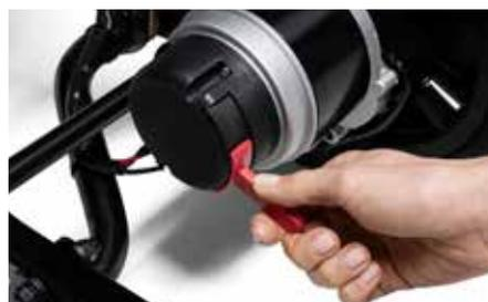
Einfach in den Schiebetrieb schalten. Durch den roten Hebel kuppelt man die Räder aus...
