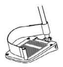
Fußplatte verstellbar für festes Beinstützenoberteil
