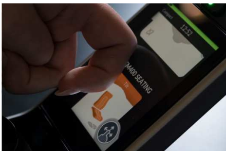
Die Invacare® LiNX®-Steuerung lässt sich durch Wischen und Tippen auf dem Touchscreen bedienen.
